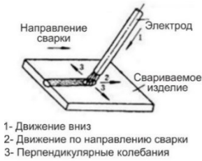
Рисунок 13.4 Три основных направления движения электрода
