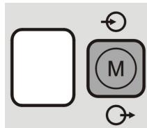
Функция памяти позволяет оператору сохранить до 9 особых процедур сварки. Кнопка памяти выполняет две функции:
