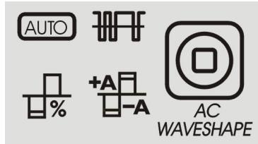
Эти значки позволяют оператору настраивать характеристики дуги для сварки TIG только для полярности AC (пер.тока).
