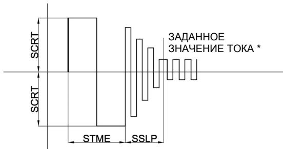
**ПРИМЕЧАНИЕ:** настройка сохраненных параметров позволяет выполнить поджиг дуги при правильно выбранном электроде (диаметр и цвет).
