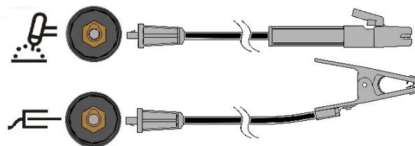
Подключите электродный кабель к терминалу горелки, а зажим заготовки - к терминалу заготовки. Вставьте соединитель с ключом, выровняв его так, чтобы выступ ключа входил в ответный паз, и поверните его на ¼ оборота по часовой стрелке. Не затягивайте слишком сильно.
