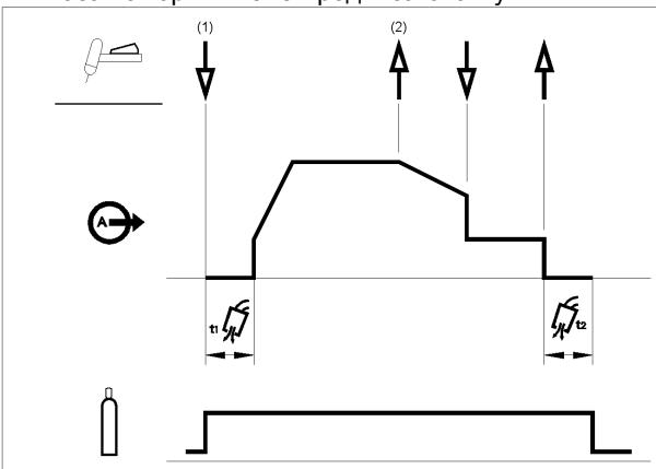
Как показано выше, можно нажать и удерживать курок TIG-горелки второй раз во время понижения тока, чтобы завершить функцию понижения и поддерживать ток сварки при токе кратера. При отпускании курка ТИГ-горелки происходит прекращение подачи сварочного тока и начинается заключительная подача защитного газа.
