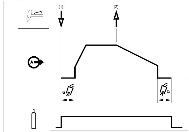
1. Нажмите и удерживайте курок TIG -горелки для запуска выполнения последовательности. При этом откроется газовый клапан и начнется подача защитного газа. После предварительной
