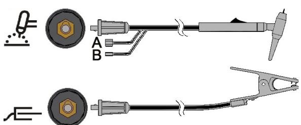
Подключите кабель горелки к терминалу горелки на аппарате, и зажим заготовки - к терминалу горелки. Вставьте соединитель с ключом, выровняв его так, чтобы выступ ключа входил в ответный паз, и поверните его на ¼ оборота по часовой стрелке. Не затягивайте слишком сильно. И наконец, присоедините газовый шланг от TIG-горелки к газовому соединителю (B) на передней части аппарата. В случае необходимости, в комплектацию включен дополнительный газовый соединитель для фитинга на передней части аппарата.
