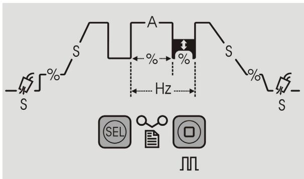
Программируемый контроллер позволяют оператору настраивать характеристики сварки TIG для обеих полярностей - AC (пер.ток) и DC (пост.ток). Нажатие кнопки «Sel» задает цикл по графику процесса.
