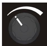
Кнопка управления основной силой тока предназначена для быстрого выбора методов настройки параметра основной силы тока. Эта функция позволяет пользователю быстро выйти из раздела программируемого контроллера тока/напряжения, устранив необходимость проходить через все возможные функции программируемого контроллера для настройки основной силы тока или выхода из меню программируемого контроллера.
