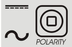
Этот значок предназначен для установки полярности процесса: операции DC+, AC MMA (stick), DC- и AC TIG.
