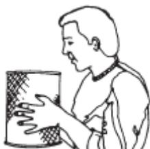
На утечку будет указывать грязный след на чистой поверхности корпуса фильтра. Перед установкой нового фильтра определите причину утечки и устраните ее.
