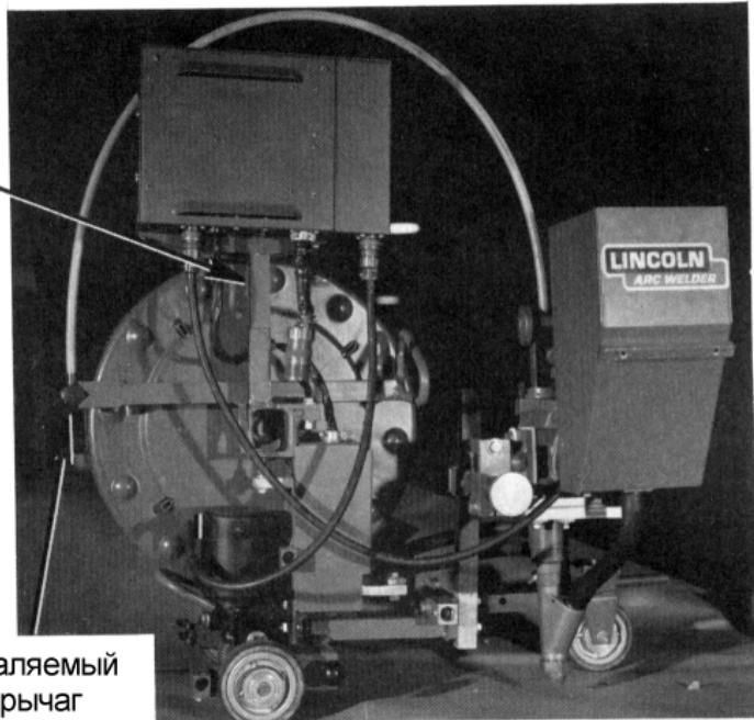
Трактор установлен для левого стыка
