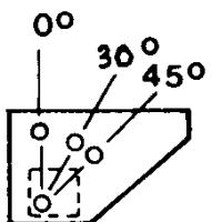
2. Установите узел поперечной регулировки (F3) на мачте, размещая его на правую сторону.
