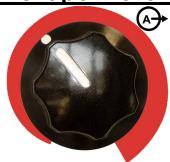
Используется для регулировки сварочного тока во время сварки.
