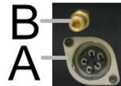
В заключение подготовки присоедините газовый шланг к соединителю на газовом баллоне. В случае необходимости, в комплектацию включен дополнительный газовый соединитель для фитинга на передней части аппарата. Далее, подсоедините фитинг на задней части аппарата к газовому регулятору на используемом баллоне. Газопровод и вся необходимая арматура также входят в комплект поставки. Присоедините курок ТИГ-горелки к соединителю курка (A) на передней части аппарата.
