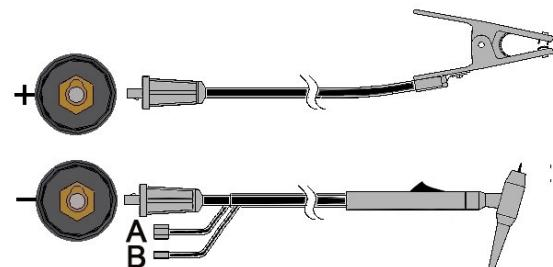
Подключите кабель горелки к терминалу (-), а зажим заготовки - к терминалу (+). Вставьте соединитель с ключом, выровняв его так, чтобы выступ ключа входил в ответный паз, и поверните его на  $\frac{1}{4}$  оборота по часовой стрелке. Не затягивайте слишком сильно.
