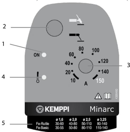
Главный выключатель и индикаторная лампа В положении "I" главного выключателя, индикаторная лампа горит и установка готова к работе. Индикаторная лампа горит всегда, когда установка подключена к электросети и выключатель находится в положении "I".
