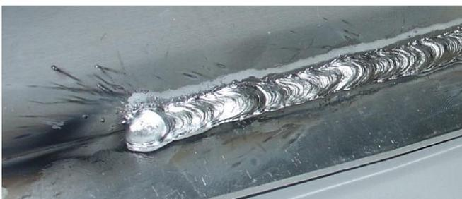
Сварка алюминия полуавтоматом Invermig 185
