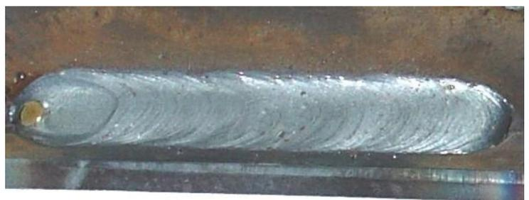
Сварка 5мм стали за один проход Invermig 185
