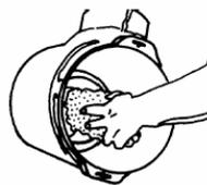
Используя чистую ветошь, очистите корпус фильтра изнутри, не допуская попадания грязи в двигатель (попадание даже незначительного кол-ва грязи может привести к выходу из
