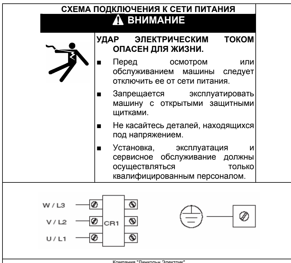
РИСУНОК А.1 - СХЕМА ПОДКЛЮЧЕНИЯ, РАСПОЛОЖЕННАЯ НА ВНУТРЕННЕЙ СТОРОНЕ КРЫШКИ РАСПРЕДЕЛИТЕЛЬНОЙ КОРОБКИ
