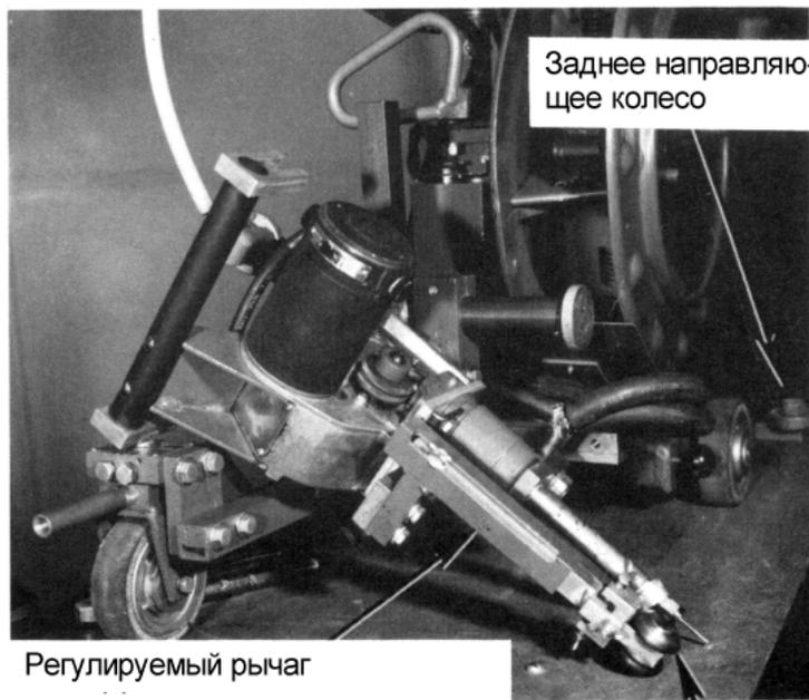
K232 Направляющие для нахлесточно-угловых соединений включает: регулируемый рычаг, переднее и заднее направляющие колеса
