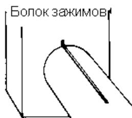
5. Установить съемную трубку бобины, чтобы предотвратить контакт с электрически "горячим" электродом. Вставьте нейлоновую трубку в съемное соединение рычага. Пропустите электрод через трубку и выпрямитель проволоки к приводным роликам. Подайте электрод вниз через сопло.
