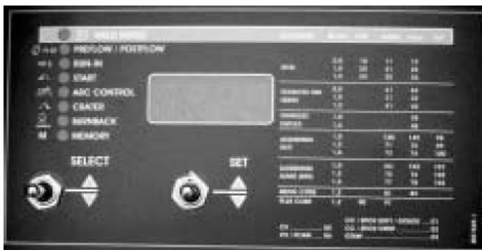
На панели MSP3 представлено свыше 30 программ, которые можно реализовать с помощью данного оборудования. С помощью тумблера SELECT можно выбрать девять вспомогательных функций для установки сварочного режима: PREFLOW, RUN-IN, ARC CONTROL, BURNBACK, POSTFLOW, START, CRATER и MEMORY. Тумблер SET позволяет установить значения параметра для выбранной функции. Отображение параметра производится на цифровом дисплее.
