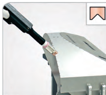
Угловой шов Прихватка на корпусе электрошкафа
