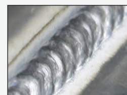
Режим Super Puls при MIG/MAG сварке: обеспечивает внешний вид TIG соединения (чешуйчатый шов)
