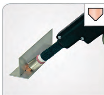
Угловой шов таврового соединения Прихватка листов
