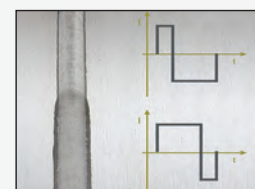
Высококачественная сварка алюминия, за счет изменения баланса переменного тока
